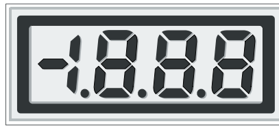
DP1 (SW6) DP2 (SW7) DP3 (SW8)
