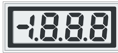
DP1 (SW6) DP2 (SW7) DP3 (SW8)
